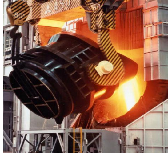
融解した金属の流し出し 2)
